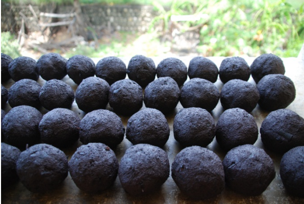
Bio-Boules, ein Brennstoff aus Abfall
