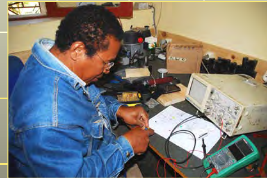
Ein eigener Akku mit Laderegler entsteht
