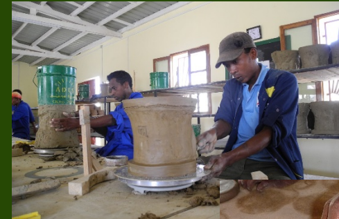
Die Mitarbeiter bringen die Brennkammern und den Kohlerost in Form
