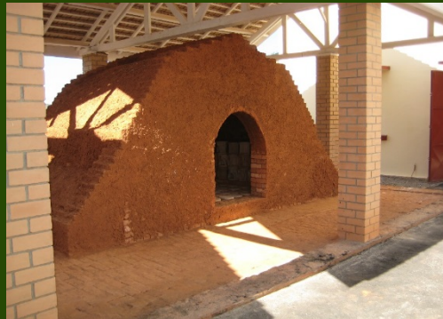
Der abschliessende Brennvorgang dauert etwa 2 Tage
