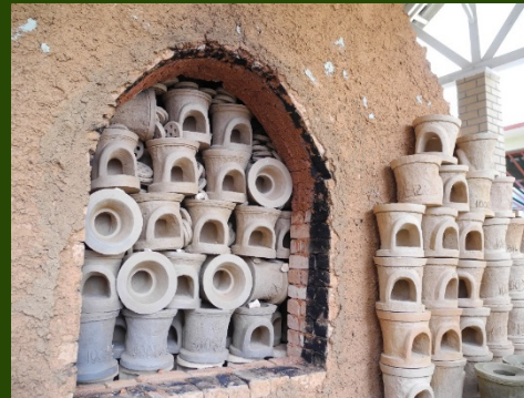
Der abschliessende Brennvorgang dauert etwa 2 Tage
