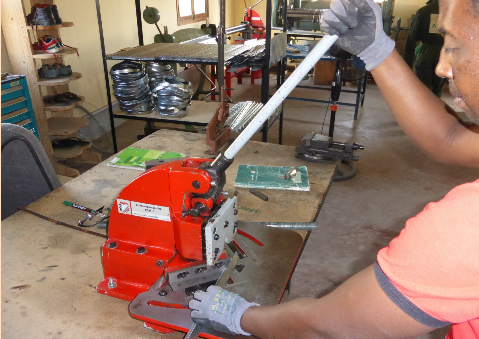
Herstellung oberer und unterer Metallring zu Kessel
