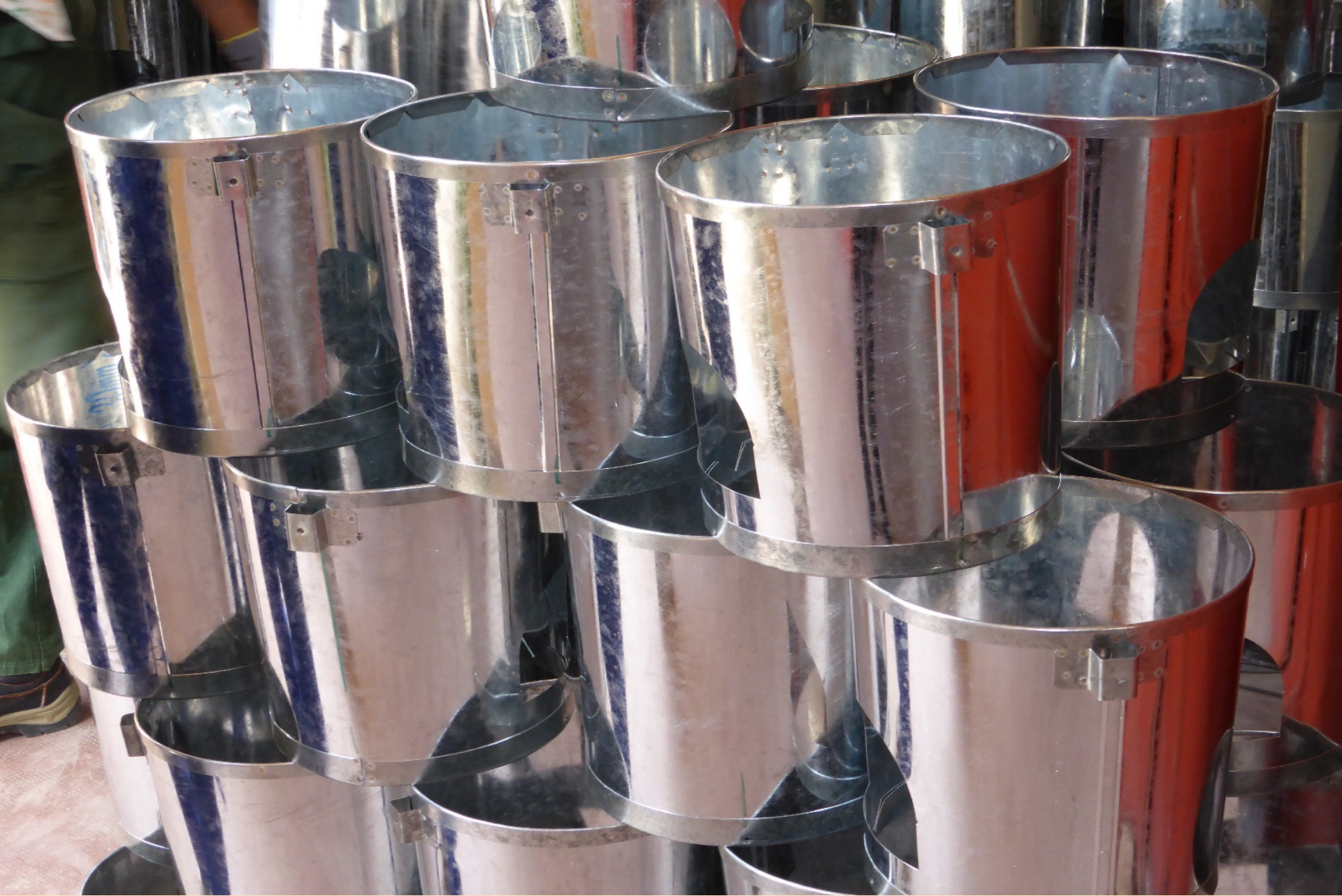
Fertige Kessel ohne Griff
