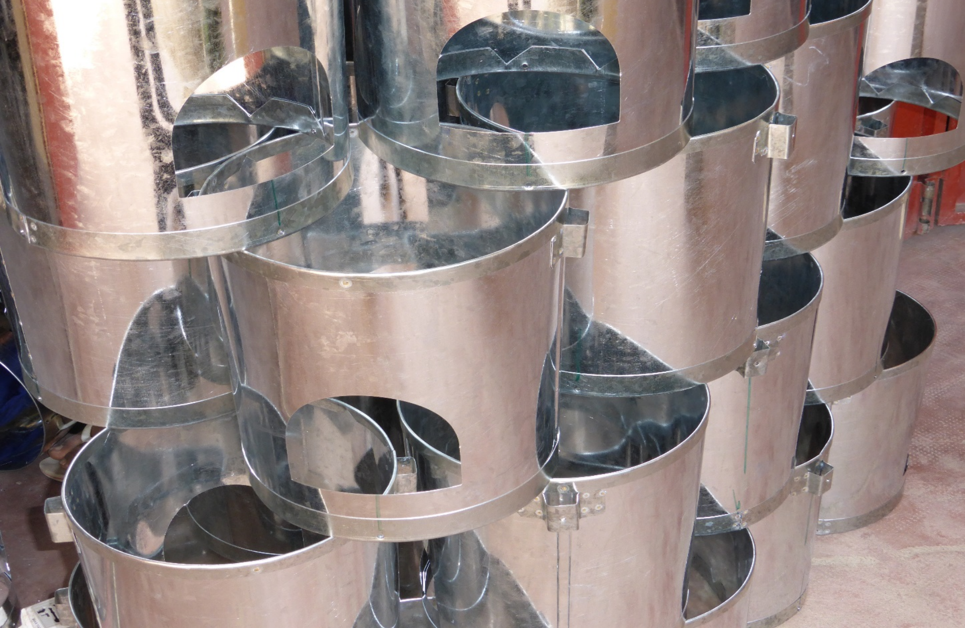
Fertige Kessel ohne Griff
