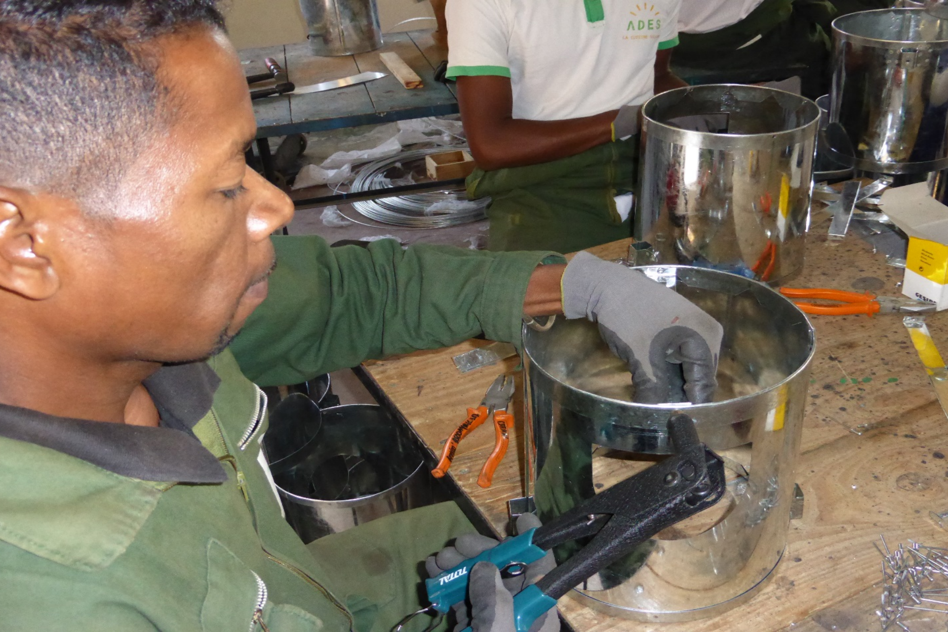
Nietung Bodenkreuz erfolgt heute durch Punktschweissen
