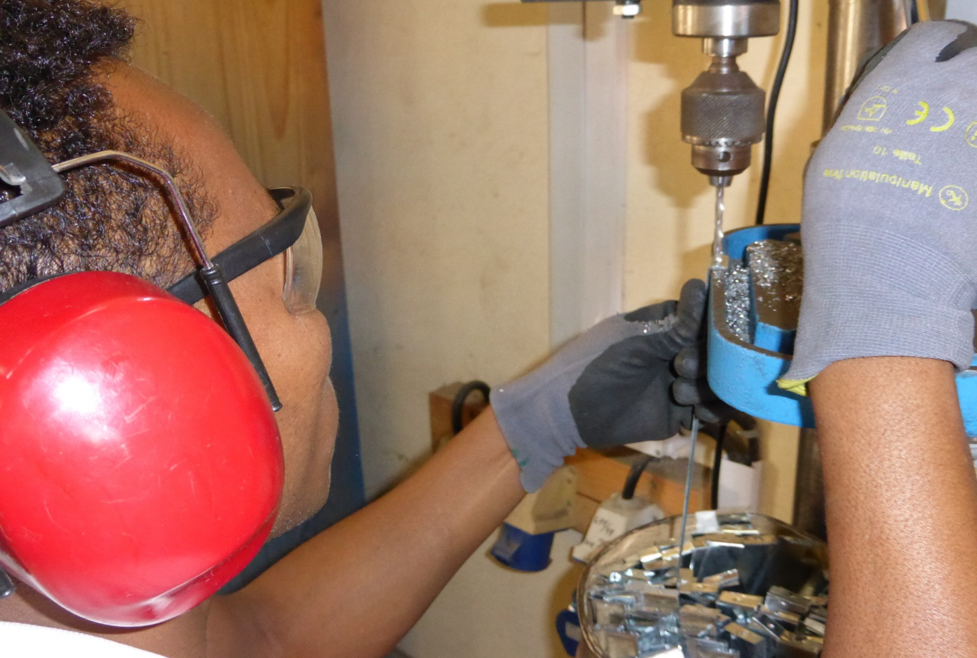
Herstellung Bodenkreuz mit Nietung
