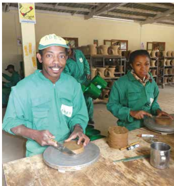
Mitarbeitende modellieren die Tonröste für die Energiesparöfen
