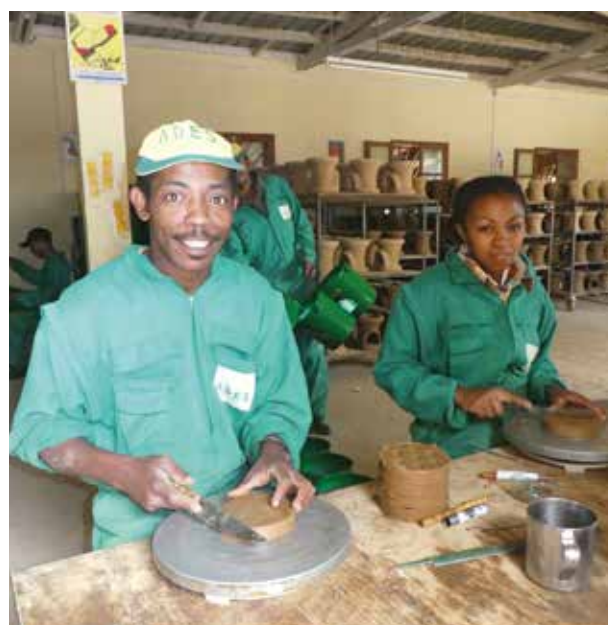
Des collaborateurs façonnent des grilles d'argile pour les foyers économes en énergie
