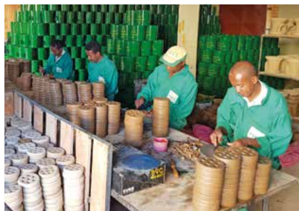
Les employés modèlent les grilles en argile pour les cuiseurs.
