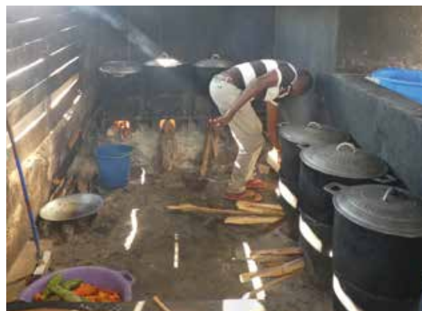
Des OLI-60b ont remplacé les anciens foyers.
