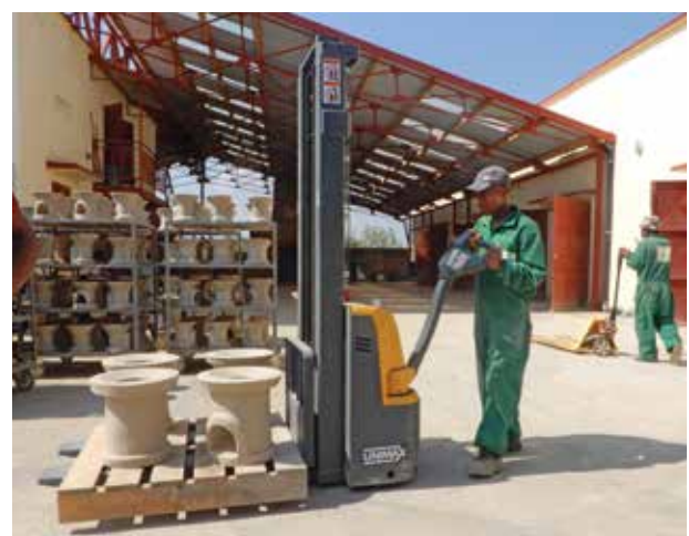
Tonkerne auf Paletten und Hubwagen. Im Hintergrund das neue Dach.
