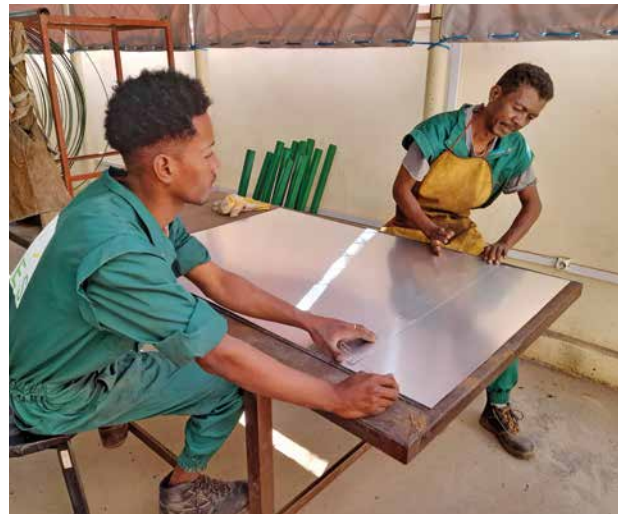
In Toliara schneiden Mitarbeiter Blech für Parabolkocher.
