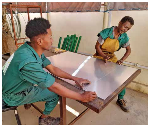
A Toliara, les collaborateurs coupent de la tôle pour des cuiseurs paraboliques.
