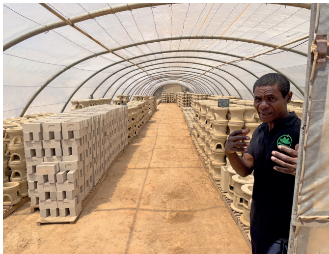
Die Trocknungsanlage für ADES Tonkerne wurde nach dem Brand bei unserer Partnerorganisation Bionerr neu gebaut.
