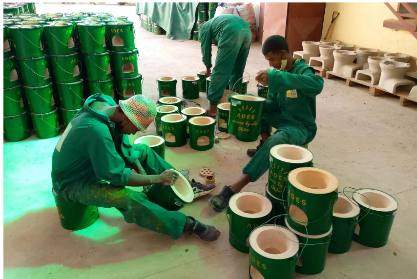
Madagassische Angestellte von Ades versehen die gebrannten Tonkerne mit einem Metallmantel.
