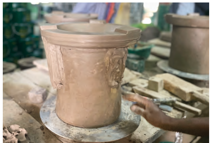
Der optimierte Tonkocher funktioniert mit Holz und Kohle.
