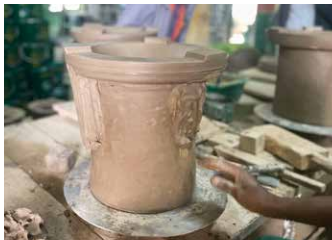
Le cuiseur en terre cuite optimisé fonctionne au bois et au charbon.
