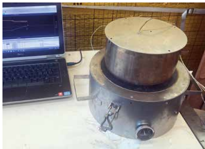
Les performances de notre prototype d'accumulateur de chaleur thermique sont mesurées.
